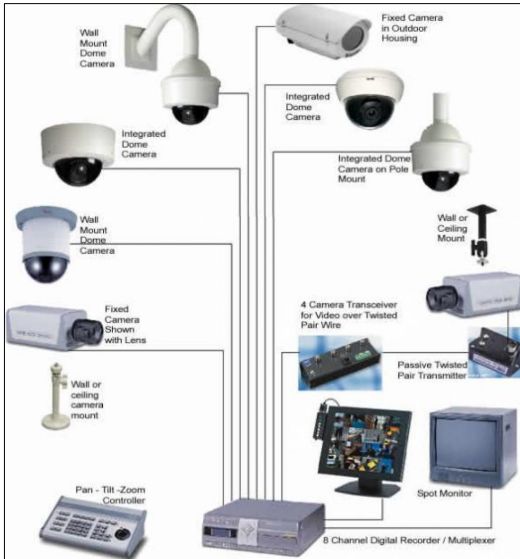
fig. 1: Componentes de un CCTV
