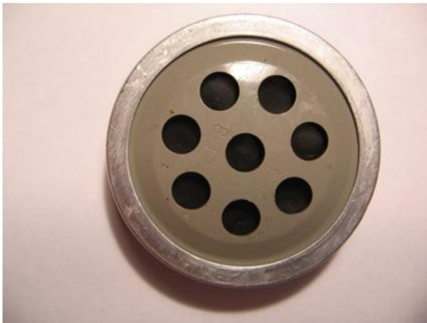
Figura B.2. Micrófono de carbón extraído de teléfono de disco
