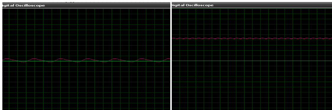
Figura 68 tensión del opto TRIAC desactivado y activado.
