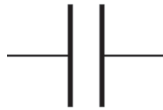
Figura 7 Simbología de un capacitor.
