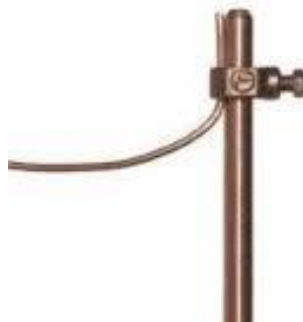
Fig. 6 Electrodo de tratamiento puesta a tierra.
