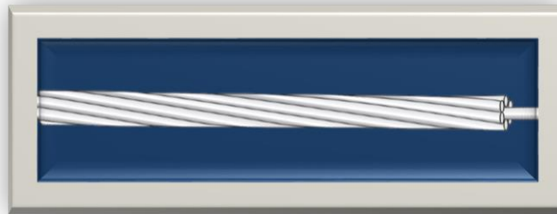
Figura 3. Conductor eléctrico de aluminio tipo ACSR
