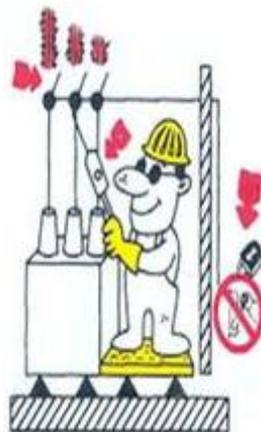
**Figura 4.6.** Verificar la ausencia de tensión
