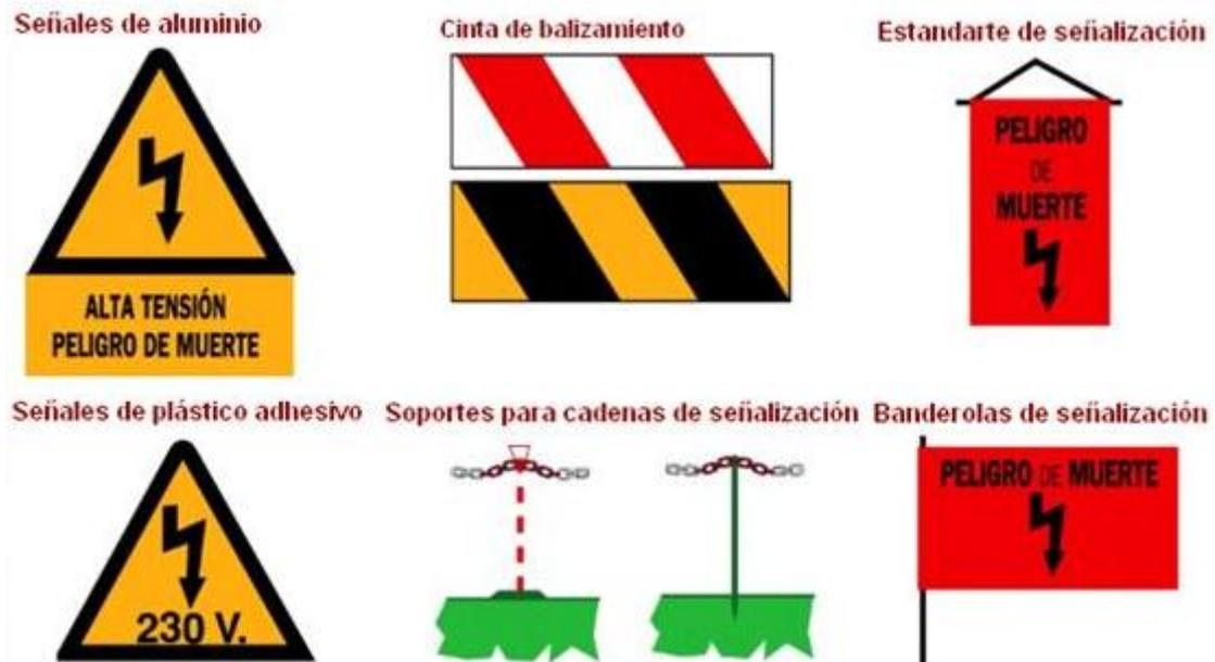
**Figura 4.10.** Tipos de señales para trabajos eléctricos
