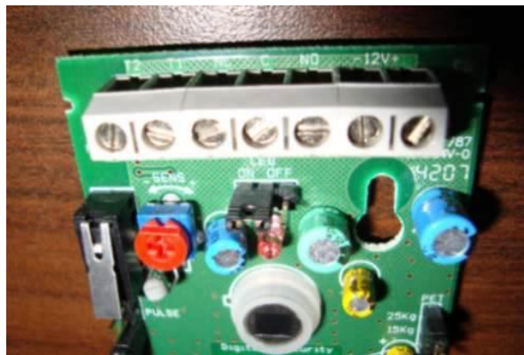
Fig.17 Borneras del sensor de movimiento DSC-585
