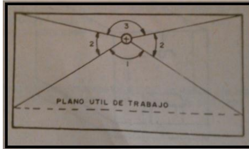
Figura 39 Distribución del flujo luminoso en un local cerrado
