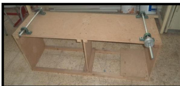
**Figura 16:** Mesa para la Banda Transportadora
