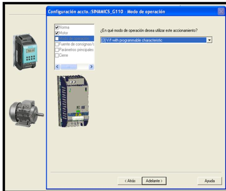
**Figura 38:** Configuración del Modo de Operación
