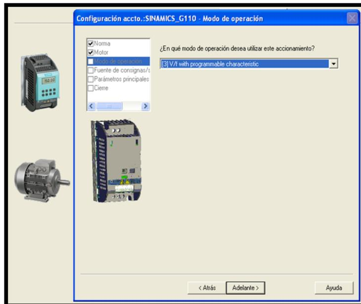
**Figura 5:** Configuración del Modo de Operación
