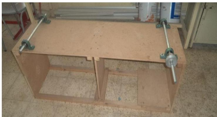
**Fig.5: Diseño de la Mesa para la Banda**
