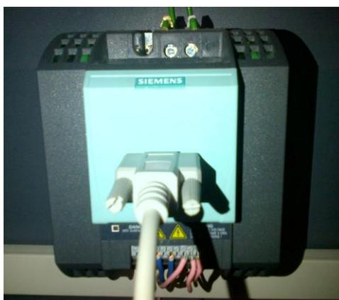
**Figura 23:** Montaje SINAMICS G110
