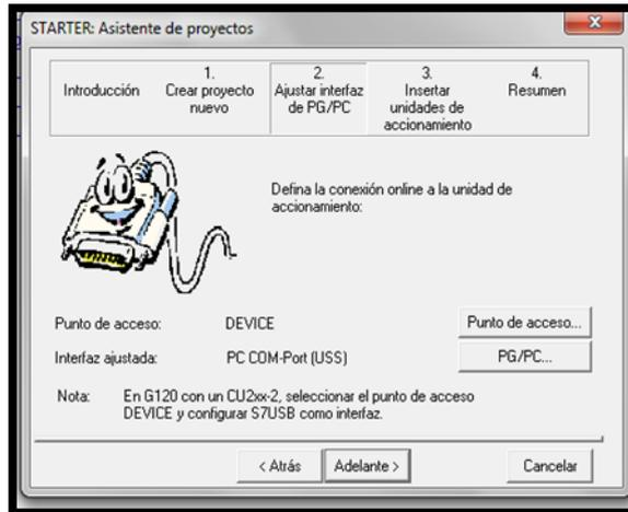
**Figura 26:** Configuración de Interfaz
