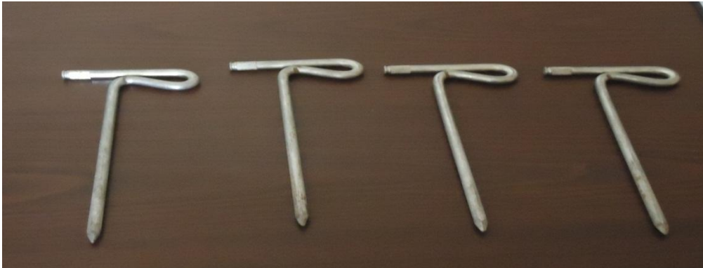
Figura 2.17. Electroodos o piquetas a tierra.
