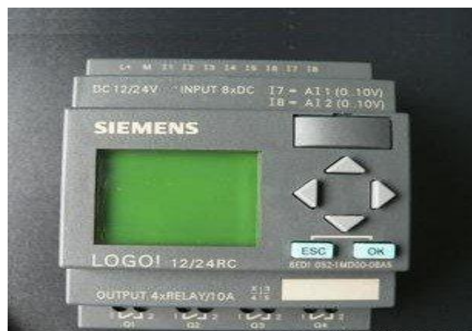
Fig. 1 Imagen de un PLC LOGO! 12/24 RC.
