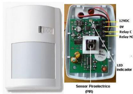
Fig. 5.1. Conexión del Sensor de Movimiento
