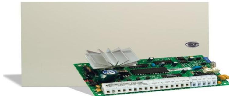
La conexión y alimentación de tarjeta se lo hace con una tensión de 12 voltios C.A mediante un transformador.
