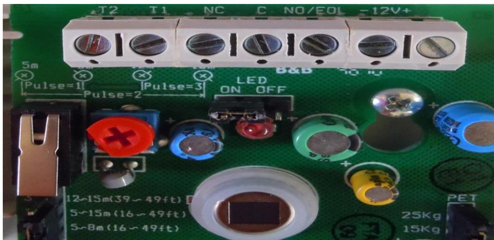
**Fig.4.13. borneras del sensor de movimiento**
