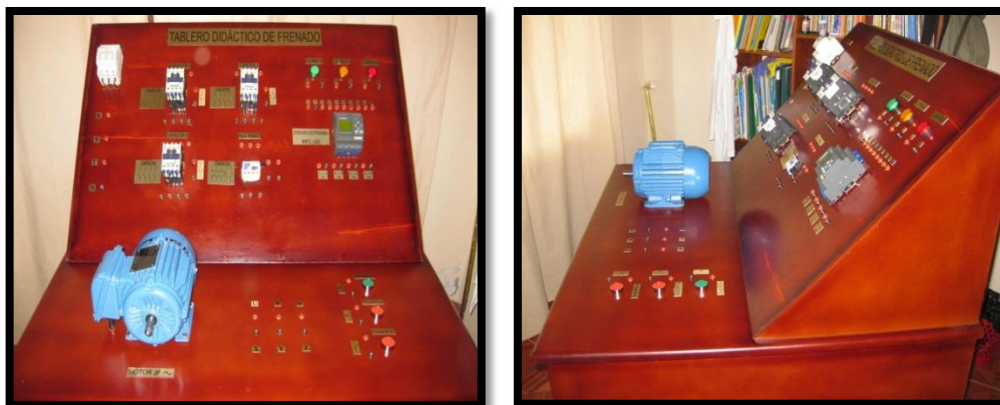
Figura 1 (Tablero didáctico de frenado por contracorriente)
