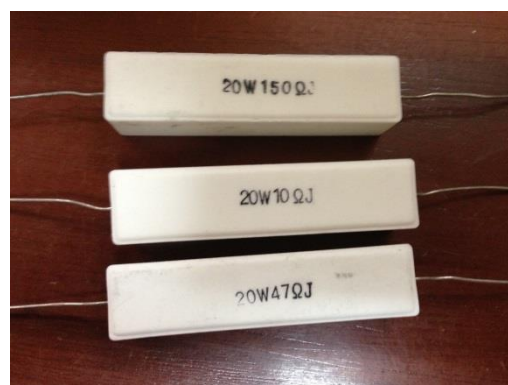
Fig. 2. Código de resistencias mediante letras y cifras.
