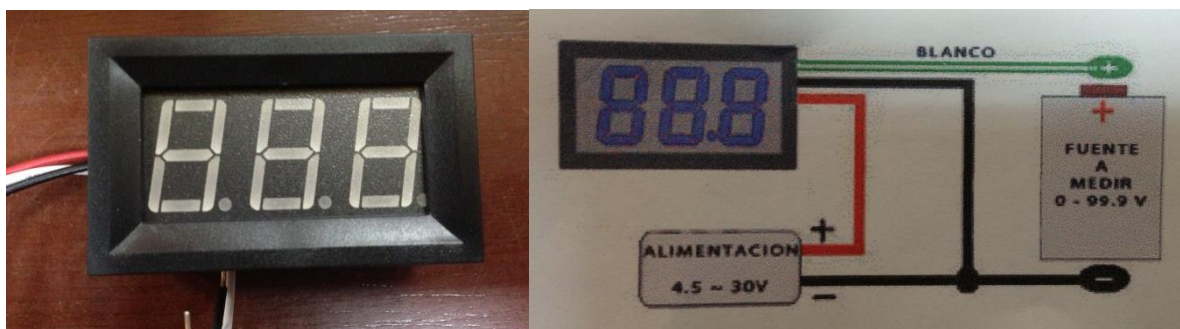
Fig. 10. Voltímetro digital y diagrama de conexión
