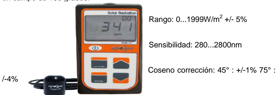
Fig. 19 Piranómetro utilizado en las prácticas
