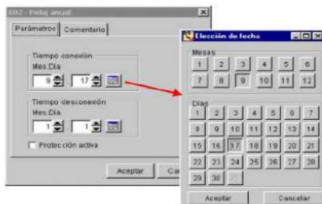
Figura 92. Parámetros de temporizador anual.
