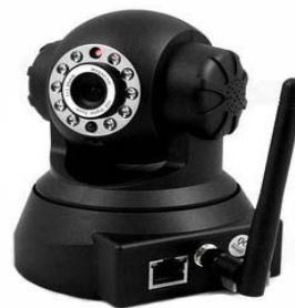
Ilustración 11. Base giratoria para fijarla a la pared o al techo.
