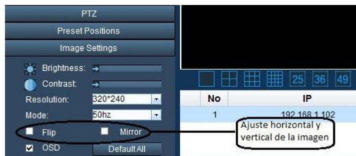
Fig.15. Ajuste horizontal y vertical de la imagen.
