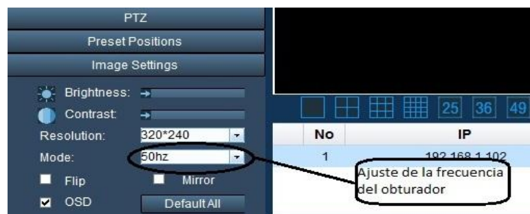
Fig.14. Ajuste de frecuencia del obturador.
