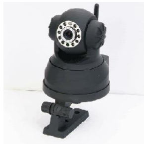
Ilustración 10. Base giratoria para fijarla a la pared o al techo.
