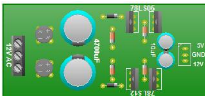
Figura 4.8. Vista 3D de la Fuente de Poder
