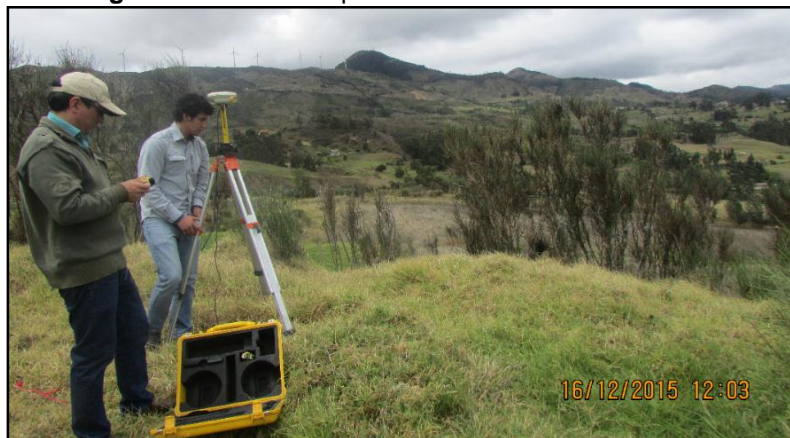
Fotografía 3.- Punto de partida de la estación TRIMBLE R8
