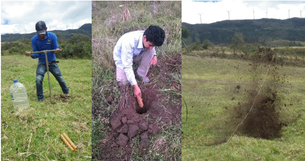
Fotografía 9.- Generación de sismo artificial
