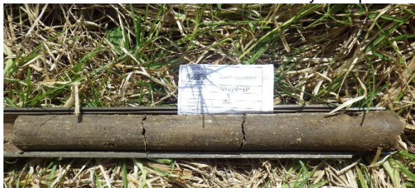
Fotografía 11.- Muestra obtenida mediante el Ensayo de penetración estándar.
