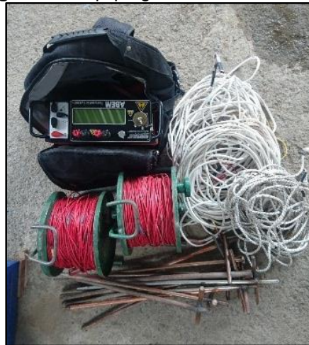
Fotografía 6.- Equipo geofísico de resistividades
