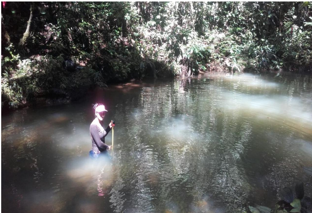
Medición del área transversal con, el fin de sacar el caudal de la microcuenca
