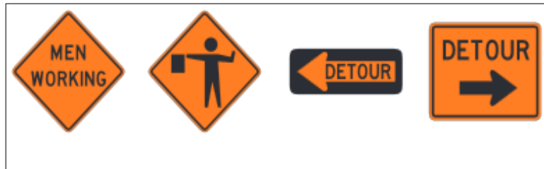
Figura N° 7 Señales y dispositivos para trabajos (Tipo
