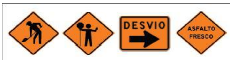
Figura N° 4. Señales para trabajos en la vía.
