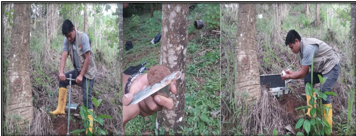
Fotografía 4.- Proceso para la toma de muestras inalteradas.
