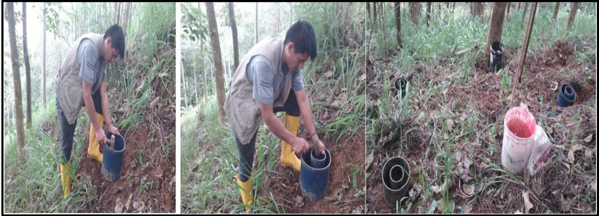
Fotografía 2.- Proceso de la colocación de los cilindros.
