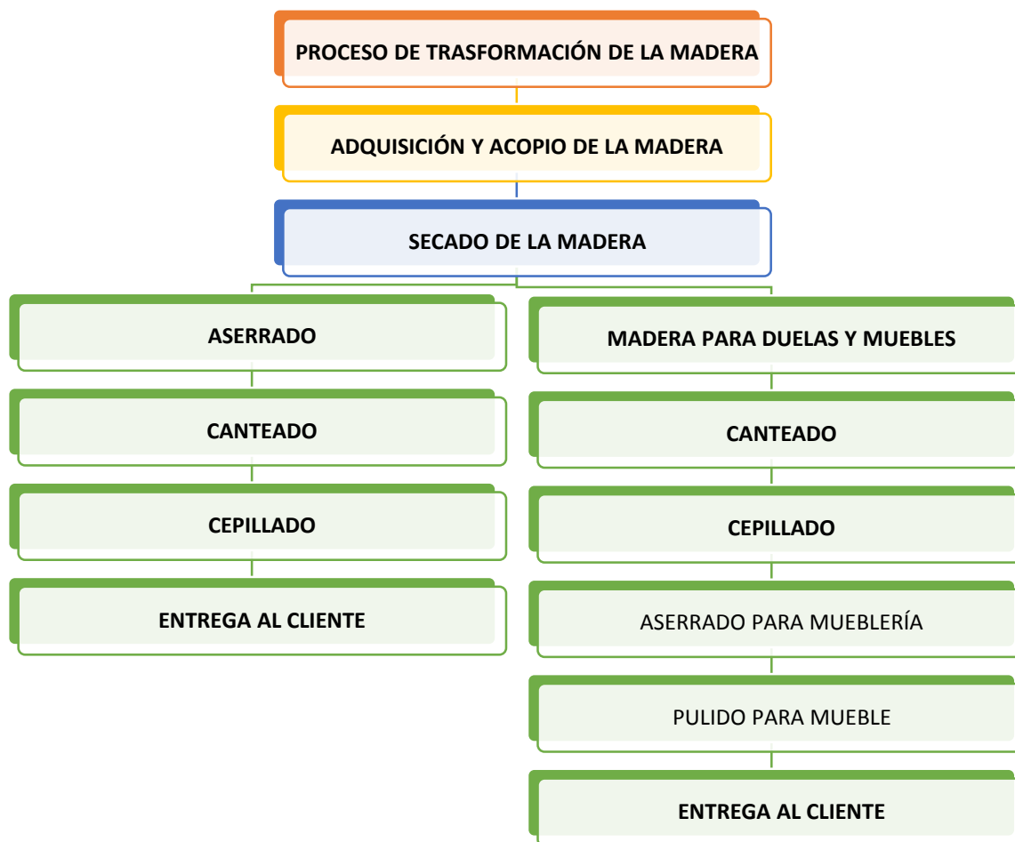
Figura 6. Diagrama del proceso de la madera.
