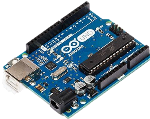
Figura 32. Arduino Uno, unidad de procesamiento (40).
