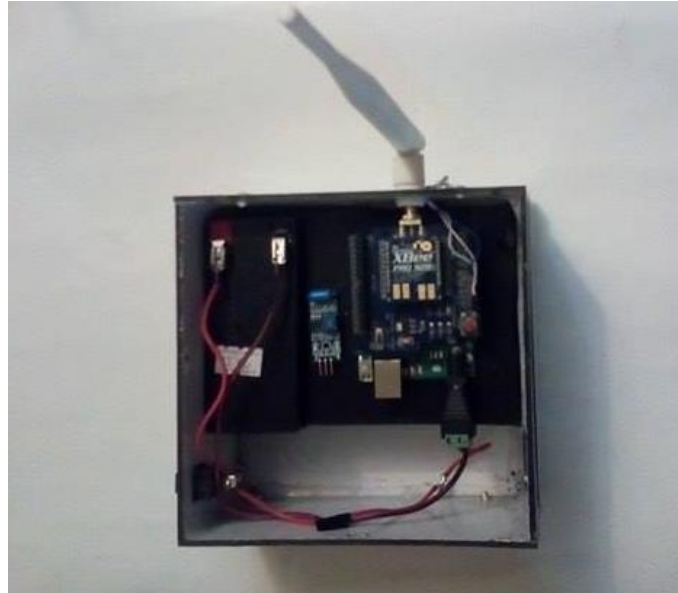
Figura 63. Constitución del nodo sensor de vibración.
