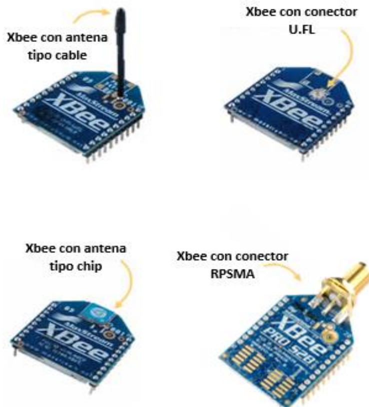
Figura 14. Tipos de antenas de módulos Xbee (31).
