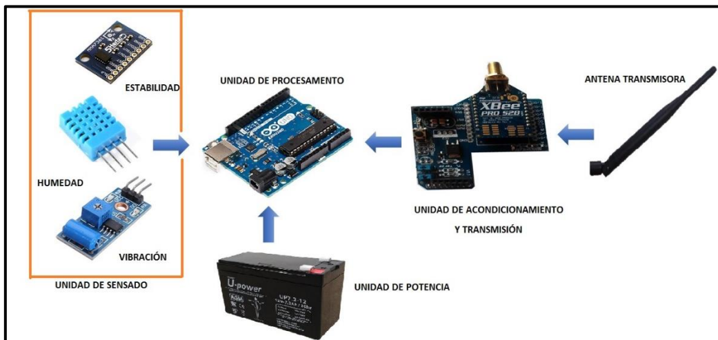
Figura 39. Conexión final del nodo sensor.
