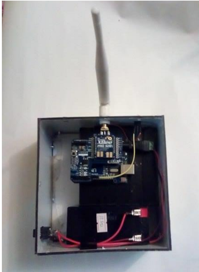
Figura 64. Constitución del nodo sensor de humedad.
