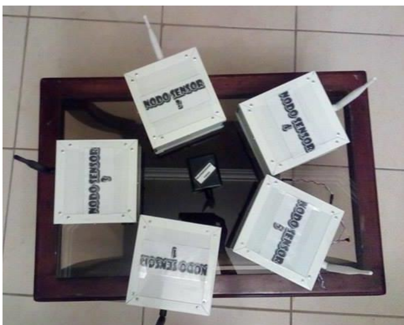
Figura 66. Conformación de la WSN con todos sus nodos.
