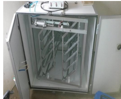
Fotografía 4. Incubadora para 600 huevos con su respectivo carro de volteo
