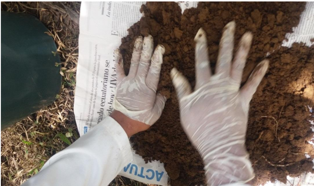
Actividad que corresponde mezcla de suelo para formar muestra compuesta de 1kg
