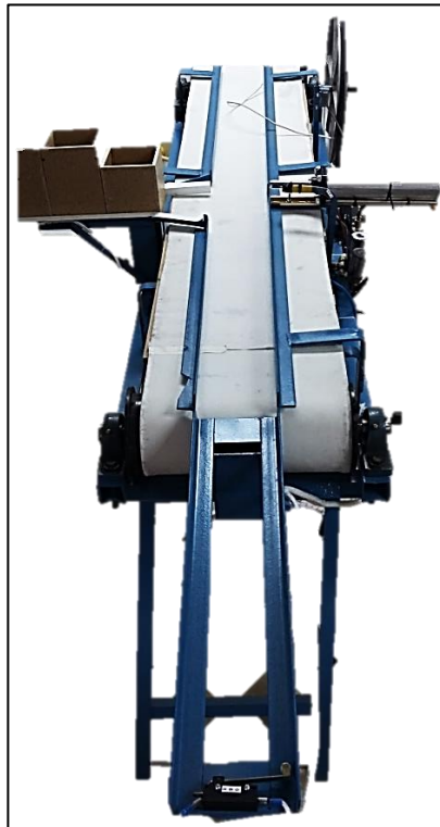
Figura 26. Montaje de sensores y actuadores en la banda transportadora.
