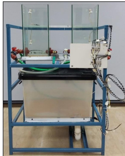
Figura 28. Montaje eléctrico de los tanques de nivel Fuente: Autor
