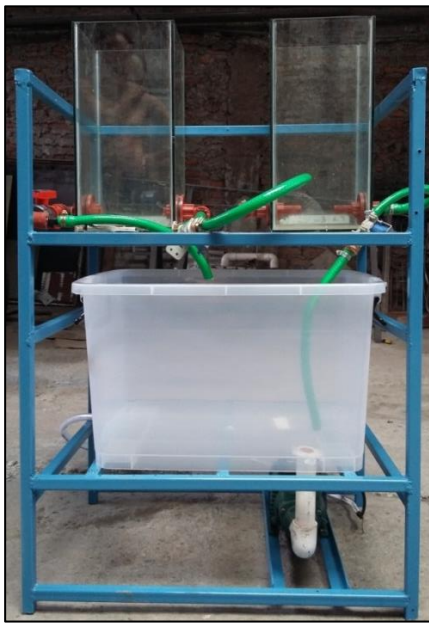
Figura 27. Montaje de la tubería para los tanques de nivel Fuente: Autor
