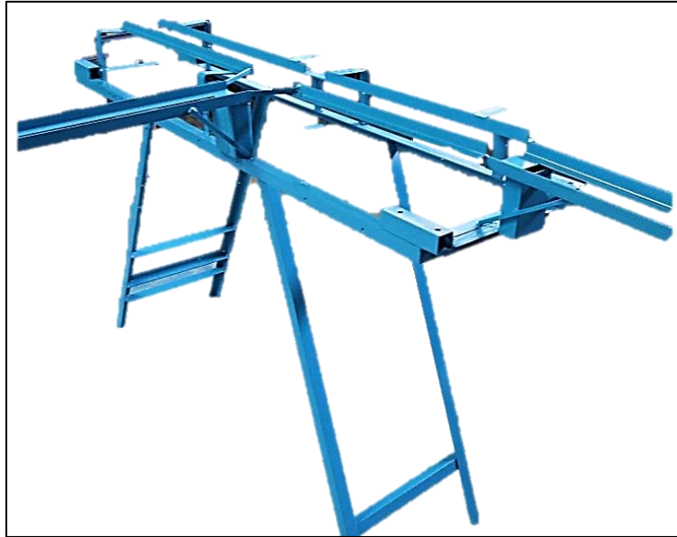
Figura 25. Estructura agregada a la banda transportadora
