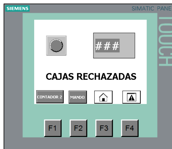
Figura 101. Programación de cajas rechazadas del HMI
