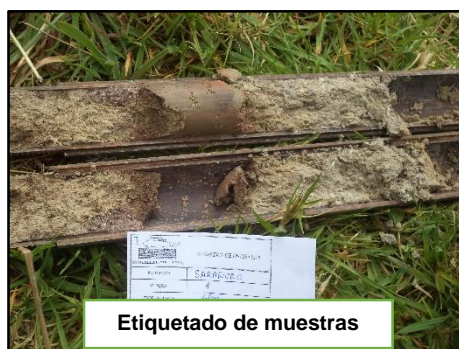
Fotografía 4. Procedimiento de campo para el SPT Fuente: El autor, 2016.
