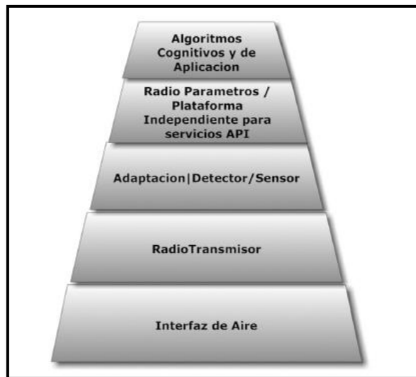
Figura 39. Modelo de un sistema de radio cognitivo. [27]
