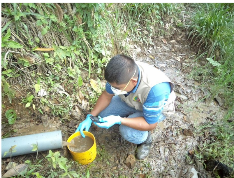
Fotografía 10. Aforo del agua residual doméstica
