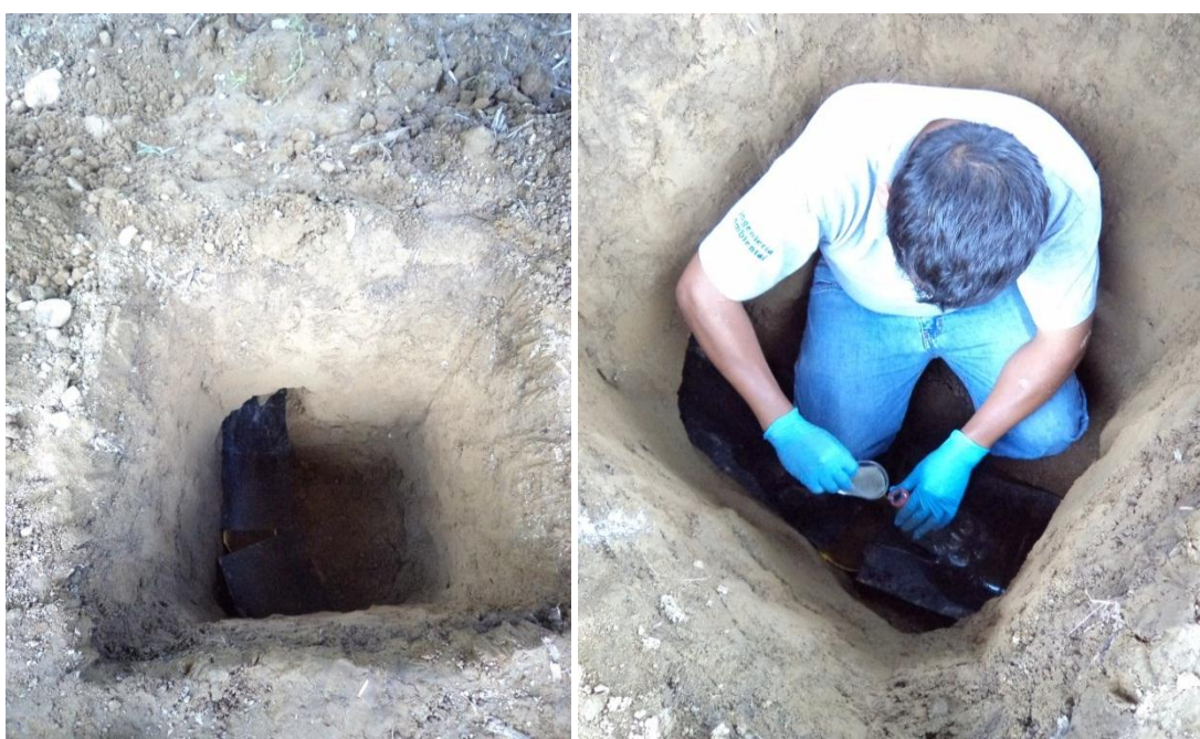
Fotografía 11. Excavación de una calicata y recolección de la muestra de agua residual tratada
