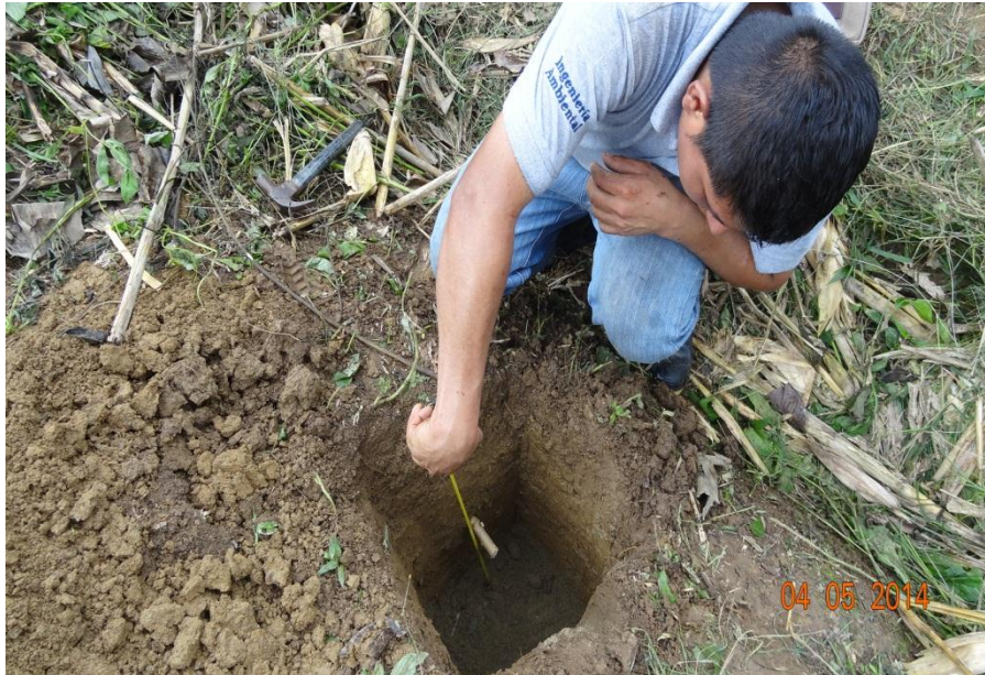
Fotografía 5. Colocación de una cuña de madera en el pozo
