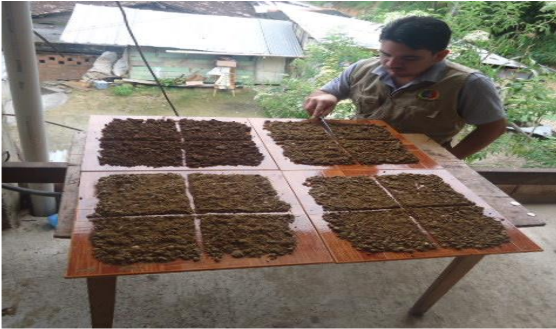
Fotografía 2. Selección de muestras a través del método del cuarteo
