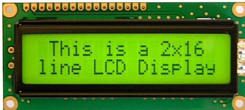
*Fig. 6. Pantalla LCD para visualización de información. ( Valadez L.A., Produccion de hortalizas Editores. 4° reimpresión. México, D. F)*
