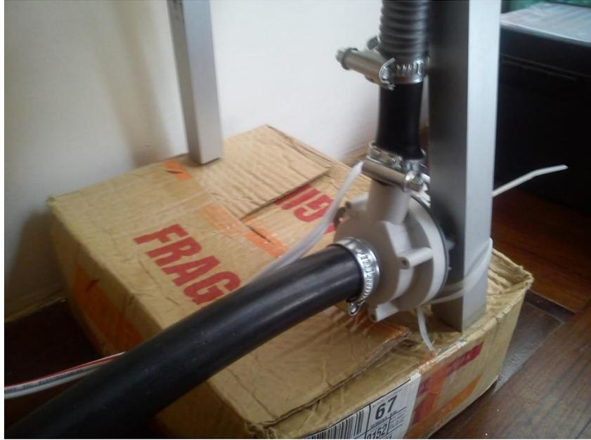
*Fig. 15. Conexión de la bomba encargada de distribuir el agua al circuito.*
