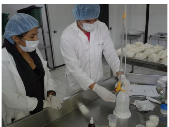
Foto 12. Prueba de acidez con el acidómetro Dornic, calibrado para acidez en leche.
