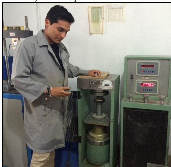
Figura 6.- Ensayo a la compresión uniaxial de muestra de roca
