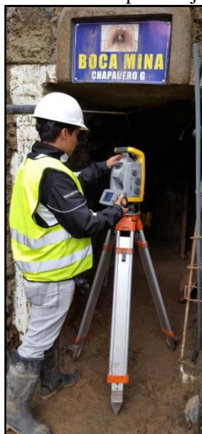
Figura 3.- Ubicación del punto fijo de control
