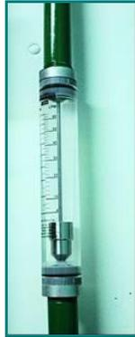
*Figura 4.6. Caudalímetro, escala 4 – 60 lts/min.*
