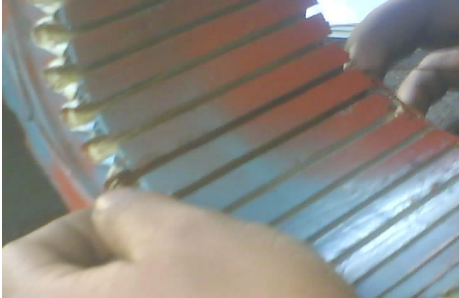
Foto 1. Colocación de aislante en las ranuras del estator para el proceso de rebobinado
