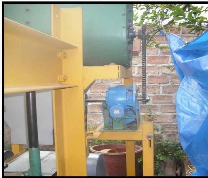
IMAGEN N° 8 MOTORREDUCTOR Y CADENA DE RODILLOS
