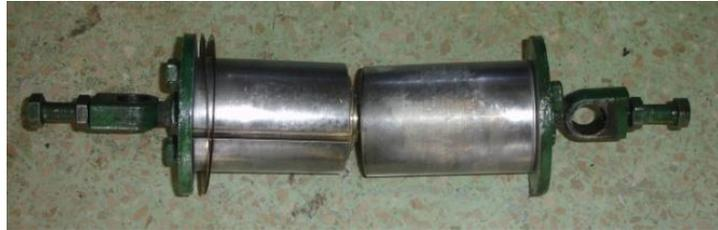
Figura # 86. Bobina del Freno del Motor
