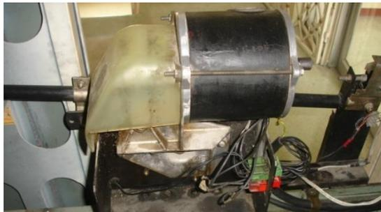
*Figura # 84. Motor de Puertas (Cambio de rodetses)*
