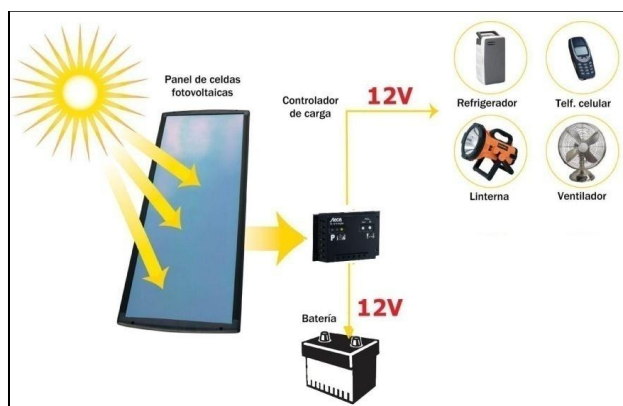
Figura 1.17: Sistema doméstico off-grid de corriente continua 19
