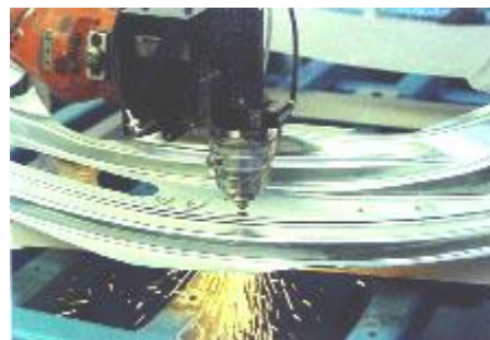
Fig. 8.- Robot con láser de corte transmitido por fibra óptica
