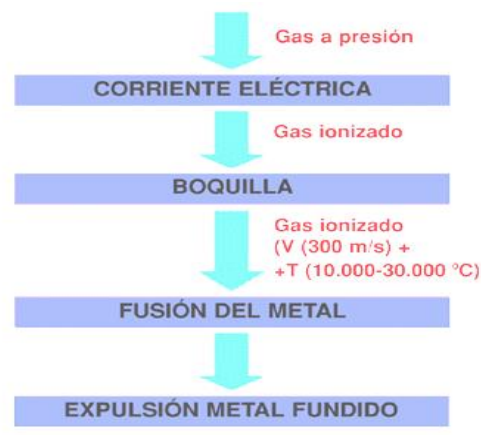
Fig. 10.- Fases del proceso de corte por plasma
