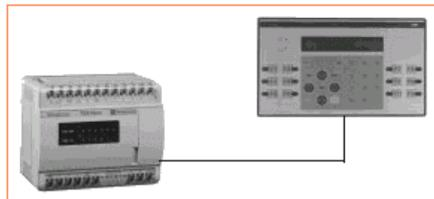
Fig. 3.8 Panel de operación y conexión de un visualizador a un autómatas
