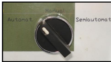
Fig.3 Selector de posición lavado Automático.
