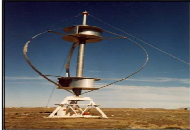
Fig. 1.3 aerogenerador de eje Vertical, patentado por Darrieus.
