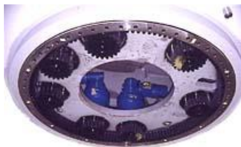
Fig.1.9. Orientación del equipo mediante conicidad
