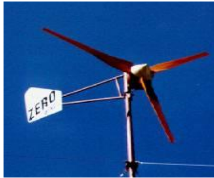
Fig.1.10. Orientación del equipo mediante una veleta.
