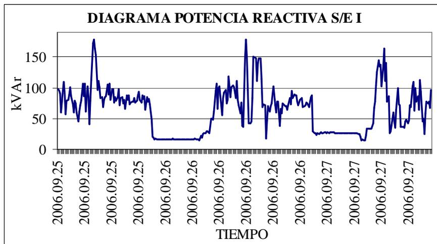
Figura 3.4 Diagrama de potencia reactiva de la subestación I
