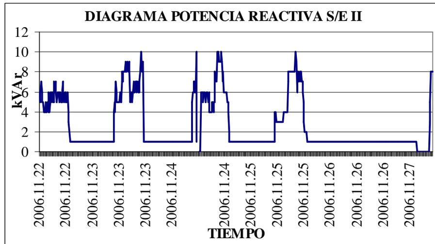
Figura 3.29 Diagrama de potencia reactiva de la subestación II.
