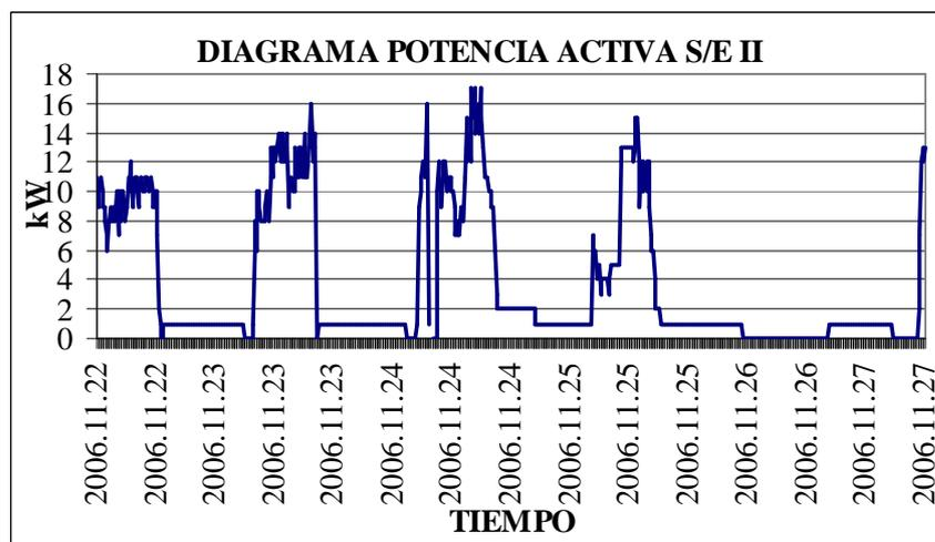
Figura 3.28 Diagrama de potencia activa de la subestación II.
