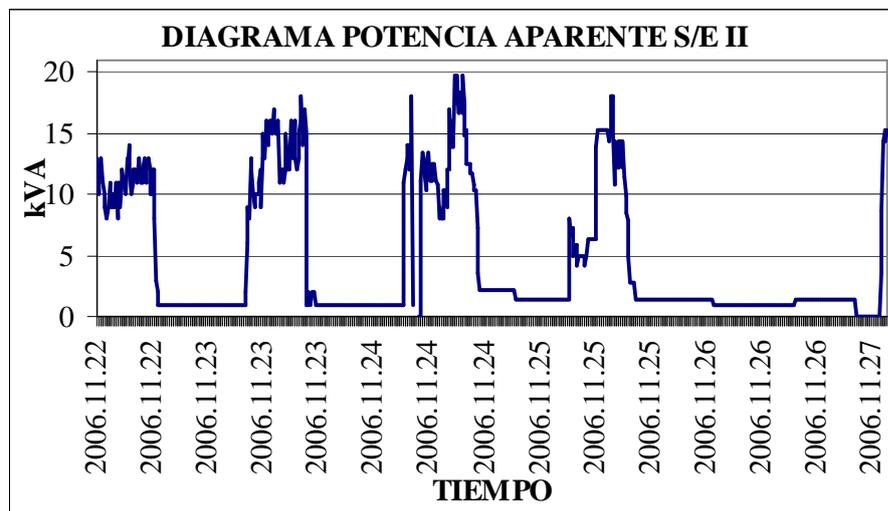
Figura 3.30 Diagrama de potencia aparente de la subestación II.
