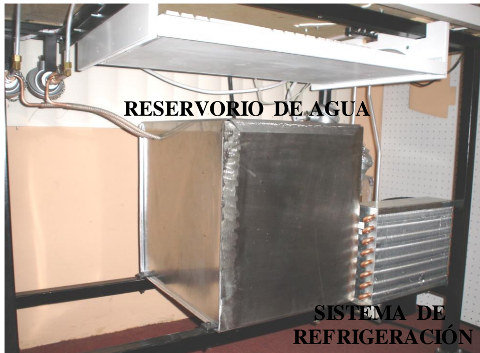
Fig. 4.4 Tanques Reservorios de Agua
