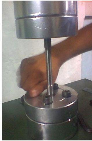
Figura 7. Roscado de los pernos en el cabezal fijo.
