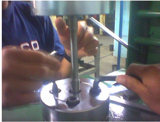
Figura 5. Desmontaje de los pernos de la mordaza fija.
