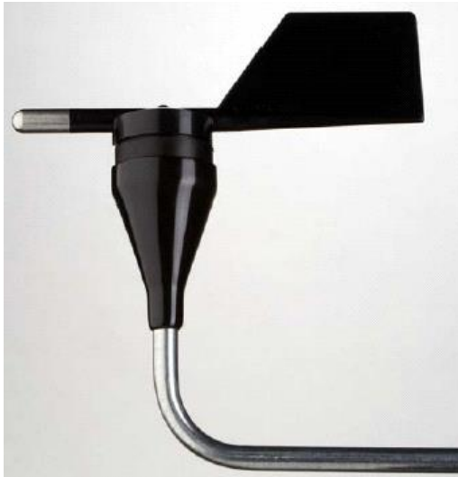
a: Veleta para dirección del viento
