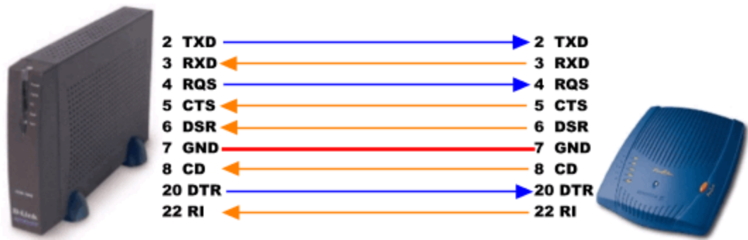
Figura 10: Conexión básica del interfaz RS232
