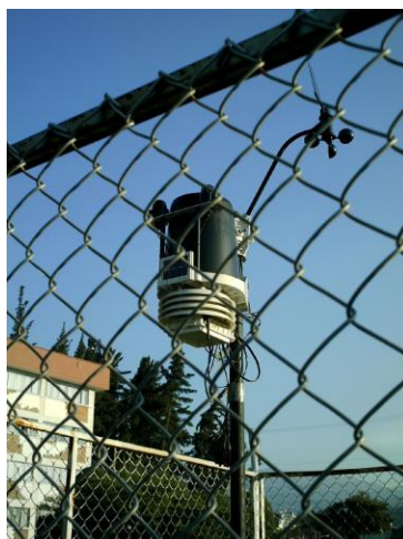
Figura 31: Estación meteorológica DAVIS
